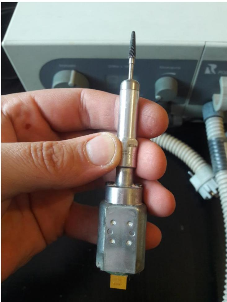
На фото ниже ручка с безщеточным микромотором в педикюрном аппарате Podotronic.
