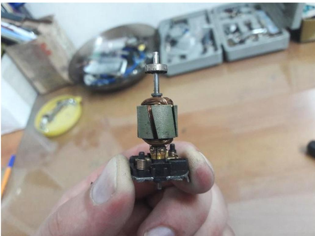
Примеры педикюрных аппаратов и стоящих в них микромоторов.
