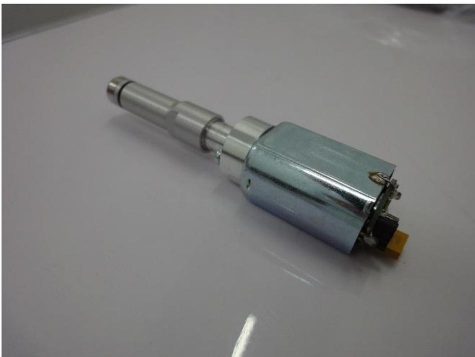
А так смотрится щеточный стандартный микро мотор в разобранном виде.
