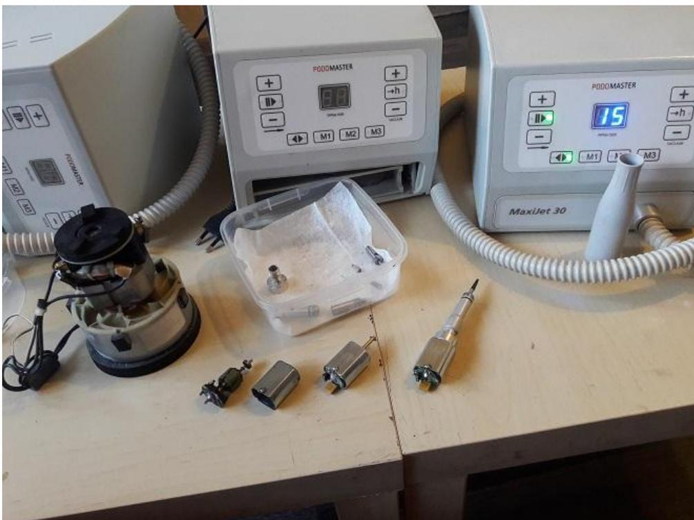
На фото родotronuic sinus III. Как видно из фото на рисунке безщеточный мотор.
